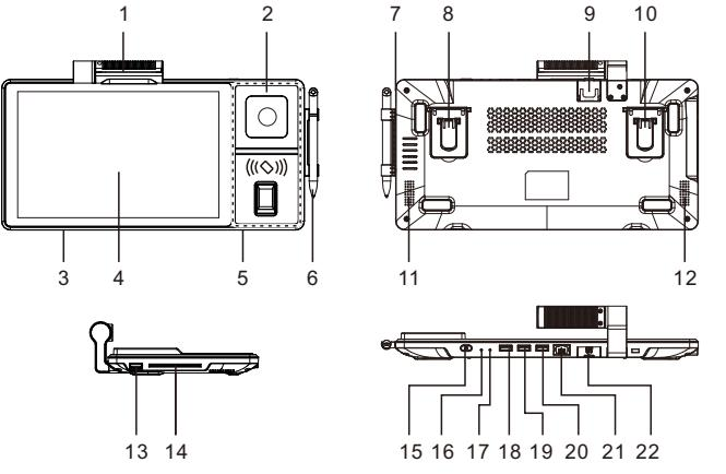
1. 镜头：垂直方向350°旋转，可通过此镜头获取视频、图像。
